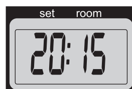
F: Når de 4 tallene slutter å blinke, er innstillingen låst med den angitte verdien.
